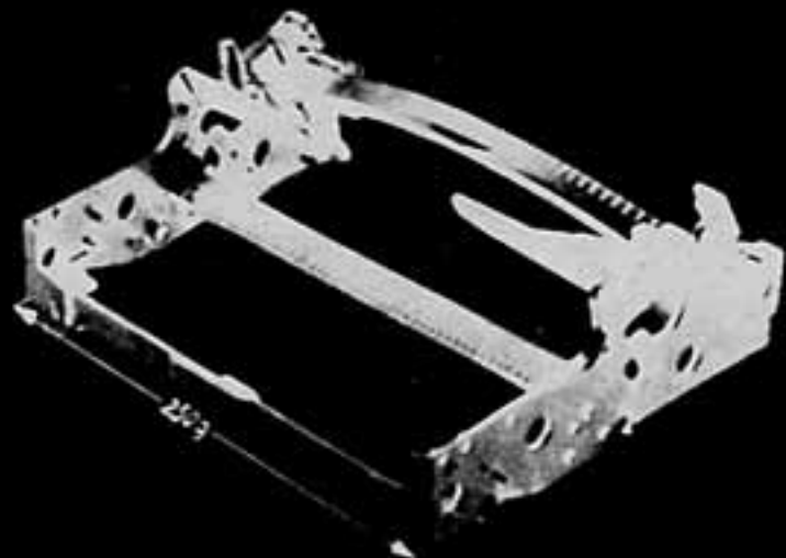
Abb. 400. Grundgestell einer Schreibmaschine. Die sichtbaren Schlitze sind mit einer Genauigkeit von \pm 0,02 mm eingespritzt.
